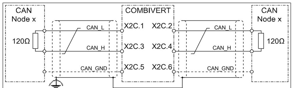
Abb. 3: Anschluss CAN-Bus
