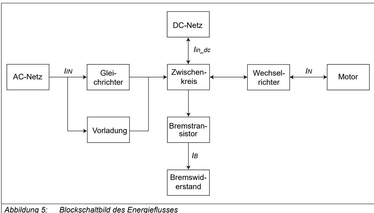
Abbildung 5: Blockschaltbild des Energieflusses
