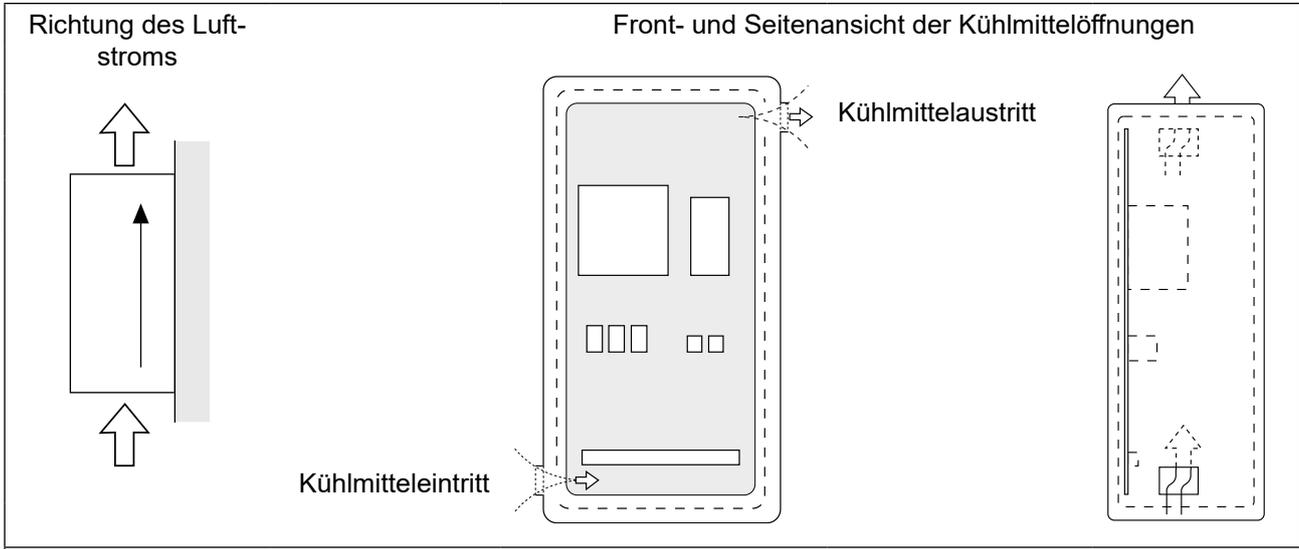
Abbildung 17: Schaltschranklüftung
