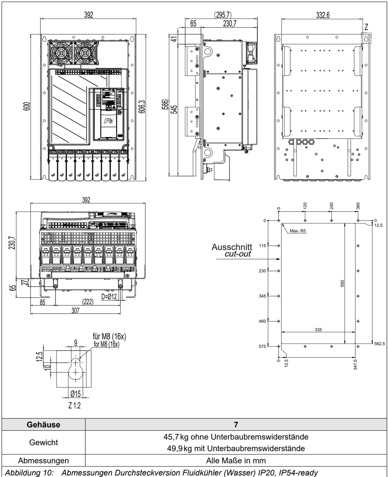
4.1.5 Einbauversion Fluidkühler (Wasser) High-Performance, IP54-ready
