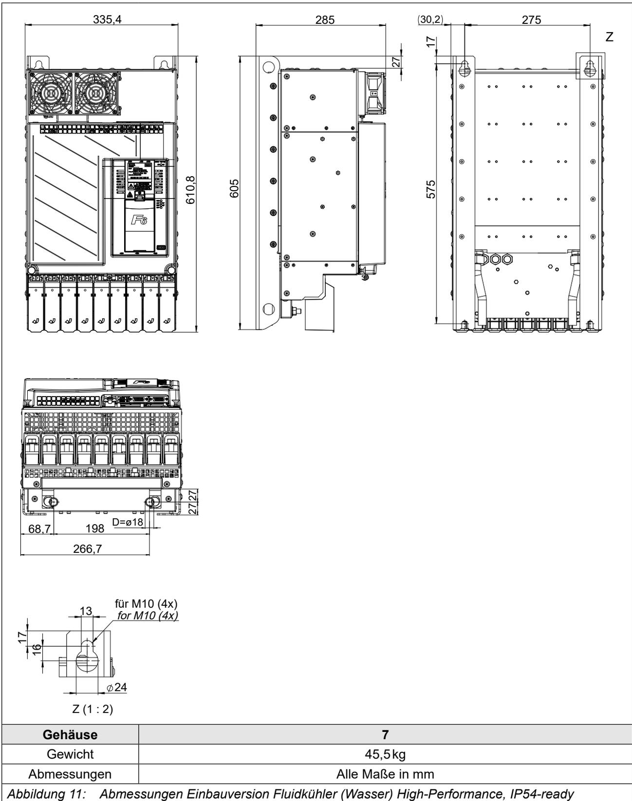
4.1.6 Durchsteckversion Fluidkühler (Wasser) High-Performance, IP54-ready
