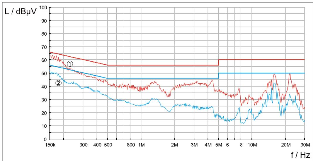
Abb. 16: 14E6T60-30xx Störspannungsmessung C1 4kHz 50m
