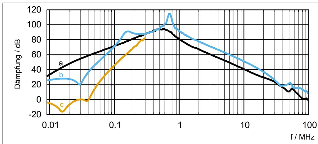
Abb. 4: 14E6T60-30xx Einfügungsdämpfung
