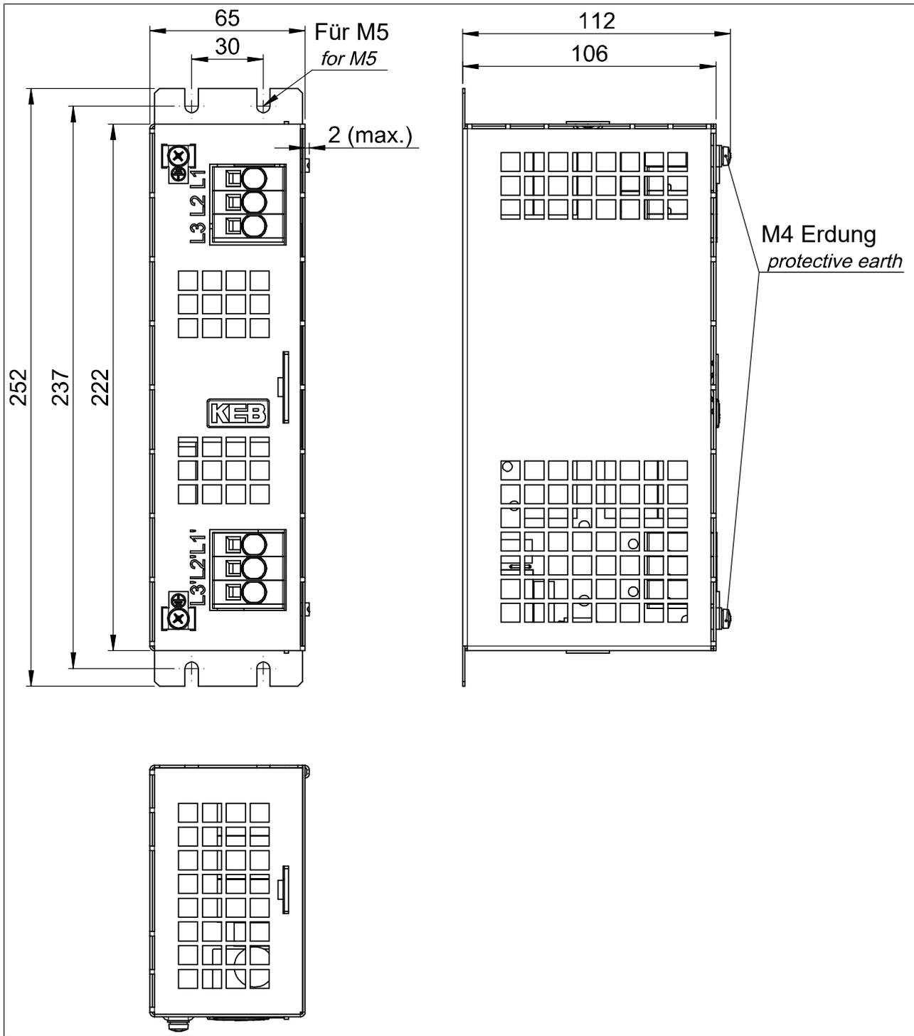
Abb. 9: Abmessungen 16E6T60-30xx
