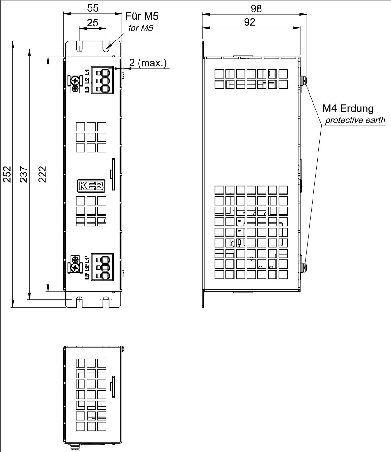
Abb. 8: Abmessungen 14E6T60-30xx
