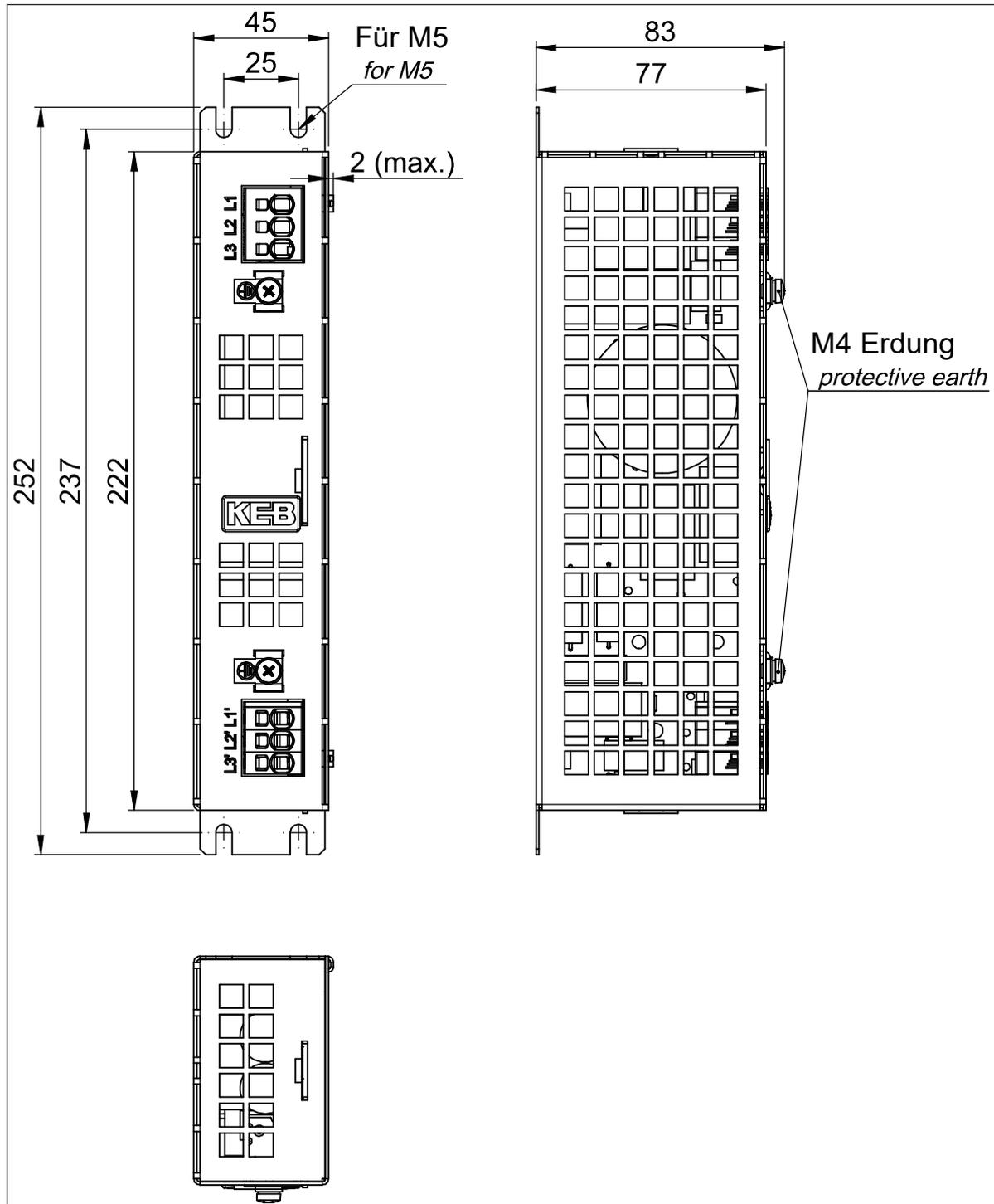
Abb. 7: Abmessungen 12E6T60-30xx
