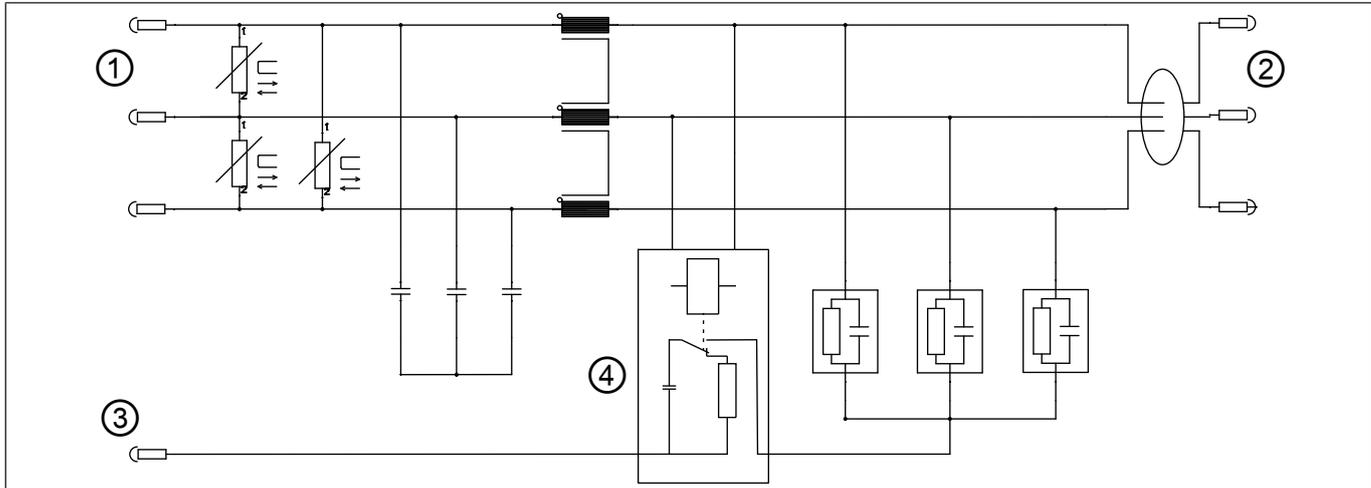
Abb. 2: Prinzipschaltbild HF-Netzfilter für IT, TN und TT-Netze
