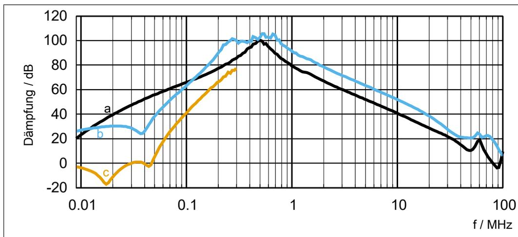
Abb. 5: 16E6T60-30xx Einfügungsdämpfung
