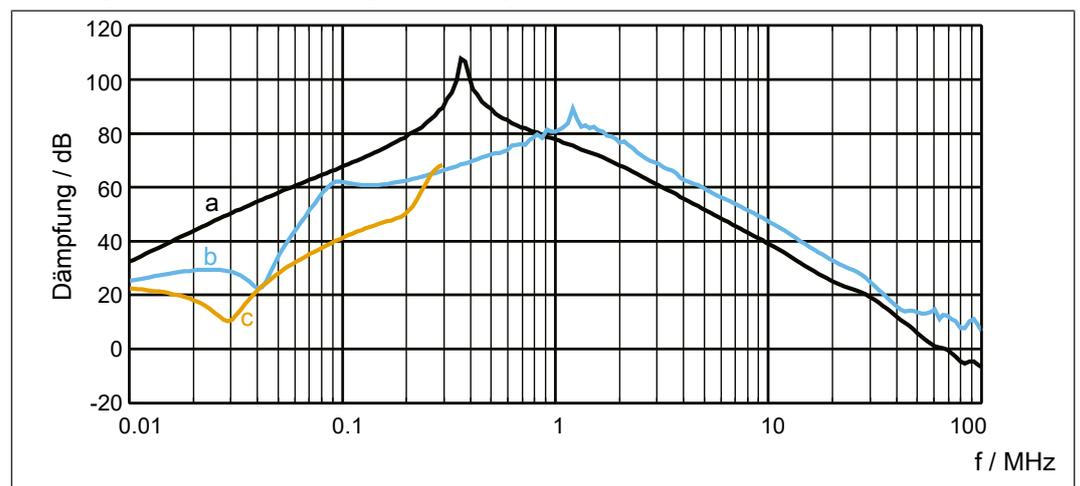
Abb. 3: 12E6T60-30xx Einfügungsdämpfung
