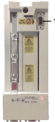
Abb. 14: Anschluss COMBIVERT F5 Klemme X4A
