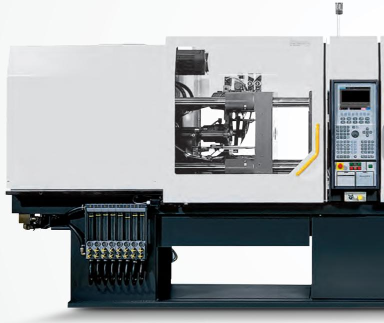
Neben dem COMBIVERT H6 und F6 für vollelektrische Lösungen bietet KEB auch die Funktion der Servopumpen-Regelung für hybride Maschinenlösungen. Die Anpassung der Pumpendrehzahl im Teillastbereich und außerhalb des Maschinenzyklus in Kombination mit einer Volumenstrom- oder Druckregelung direkt über das Pumpensystem, bietet bis zu 70 Prozent Energieeinsparpotenzial, in Hydrauliksystemen.
